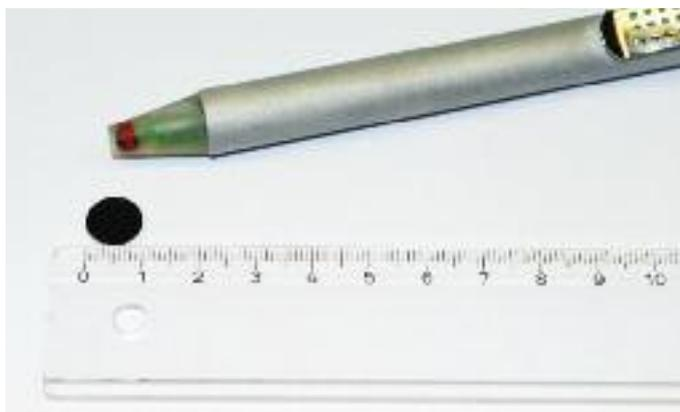
Abb. 1: Transponder mit Schreib- und Lesegerät zur Verwendung mit einem externen Computer
