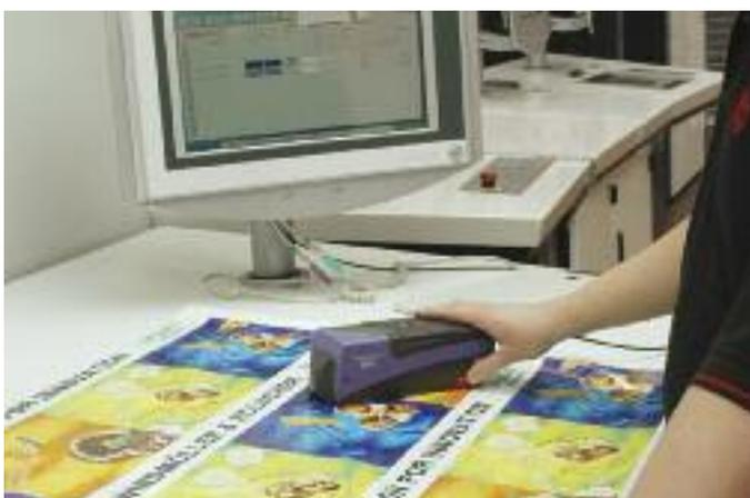
Abb. 7: Spektralphotometrische Bestimmung des Farbortes mit Easy-Col.
