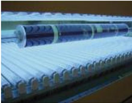
Abb. 3: nyloflex® ITR Exposure kann gleichzeitig zwei polymere ITR Sleeves belichten.
