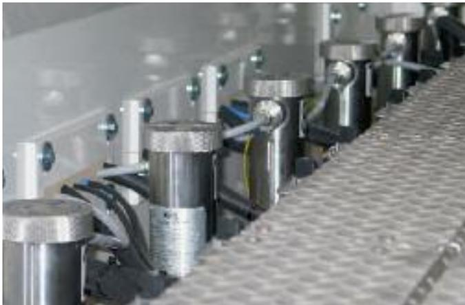
Abb. 1: Viskositätsregelanlage an TurboClean 600 A mit Ausbaustufe für zwei Reinigungsmittel.
