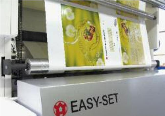
Abb. 3: Easy-Set Kamera- und Beleuchtungseinheit.
